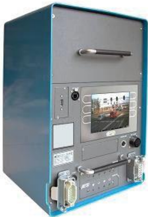
Slika 6. GTC GLD uređaj s integriranim modulima: GUI 1 komad i GLD4-2S 2 komada
