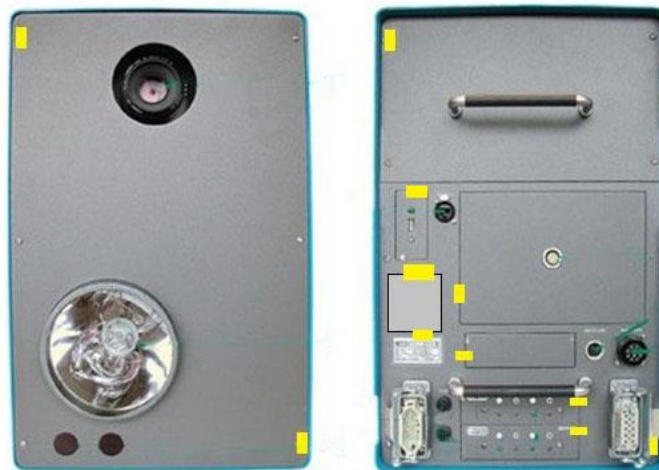
Slika 10. Smještaj ovjernih i zaštitnih naljepnica u obliku markica (za uređaj na stupu)
